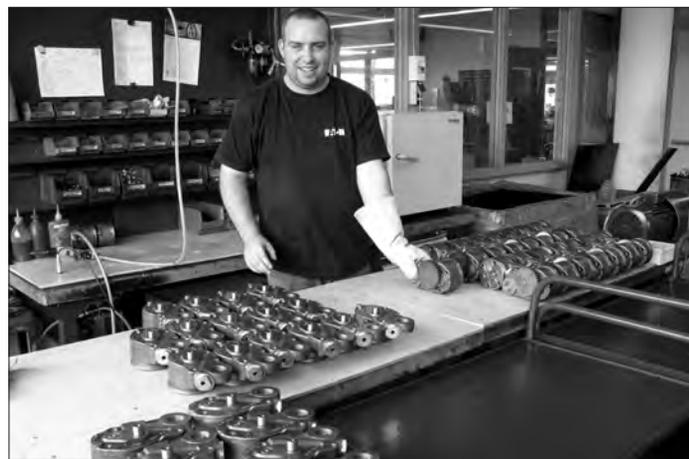
*Eine komplexe und anspruchsvolle Aufgabe: die Montage von Schmierölpumpen bei der HWK in Ettlingen.*
